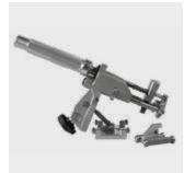
Ротационное устройство для надежного снятия оксидного слоя с труб из ПЭ-НД и РЕ-Ха. Износоустойчивый твердосплавный резец имеет 2 режущие грани (двойной срок службы). Равномерное снятие стружки посредством подпружиненного резца и автоматической подачи. Быстрая регулировка длины зачищаемой поверхности и сменного зажимного ролика для диапазонов диаметров d 75 - d 225 и d 250 - d 400. Поставляется в практичном алюминиевом контейнере для транспортировки.
