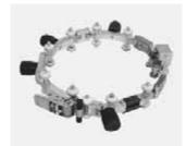
Устройство для надежного снятия оксидного слоя с концов труб из ПЭ-НД и PE-Ха разных диаметров от 250 мм до 1000 мм, а также с поверхностей для посадки седлообразных фитингов. Удобство посадки на трубу за счет открывающейся конструкции приспособления.
