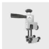
Ротационное устройство для надежного снятия оксидного слоя с труб из ПЭ-НД и РЕ-Ха. Износоустойчивый твердосплавный резец имеет 2 режущие грани (двойной срок службы). Универсальная толщина снимаемой стружки, не требуется регулировка. Равномерное снятие стружки посредством подпружиненного резца и автоматической подачи.
