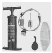
Ремонтный комплект для сдерживания остатков воды во время ремонтных и монтажных работ на водопроводах из ПЭ-НД d 90 - 900 мм. Состоит из универсального ремонтного набора (насос, манометр, сверло, соединительный шланг) и ремонтного воздушного баллона соответствующего диаметра.
