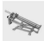
Ротационное устройство для надежного снятия оксидного слоя с труб из ПЭ-НД на половину длины или на полную длину муфты. Износоустойчивый твердосплавный резец для обеспечения длительного срока службы. Равномерное снятие стружки посредством подпружиненного резца и автоматической подачи. Запасной резец и аэрозоль-смазка для ухода за инструментом прилагаются.
