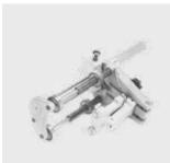
Ротационное устройство для надежного снятия оксидного слоя с патрубков фитингов без нагревательной спирали. Дополнительно возможно снятие оксидного слоя с труб из ПЭ-НД и РЕ-Ха (максимально на половину длины муфты d 710). Износоустойчивый твердосплавный резец для обеспечения длительного срока службы. Равномерное снятие стружки посредством подпружиненного резца и автоматической подачи. Запасной резец и аэрозоль-смазка для ухода за инструментом прилагаются.
