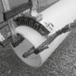
ПЭ 100 Максимальная поперечная нагрузка на FIXBLOC: 40 Кн
