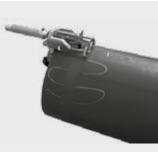
Ротационное устройство для надежного снятия оксидного слоя с труб из ПЭ-НД и РЕ-Ха. Износоустойчивый твердосплавный резец имеет 2 режущие грани (двойной срок службы). Равномерное снятие стружки посредством подпружиненного резца и автоматической подачи.
