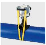
Используется для посадки на трубы и прижатия в процессе монтажа FRIALEN - седлообразных деталей типа Top-Loading всех диаметров в заданной области, используя эластичное пневматическое давление, и для создания оптимального давления расплава в зоне сварки.
