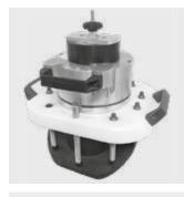
Прижимное устройство для FRIAFIT - седловидных изделий типа ASA-TL и ASA-TL/KG (см. раздел FRIAFIT), особенно для плотно прилегающих вставок из ПЭ-НД от DN 200 до DN 500 мм и труб из ПЭ-НД диаметром d 630 мм. Для прижатия и создания необходимого в зоне сварки давления в процессе сварки. Состоит из анкерного устройства, коронки (диаметр 95 мм), патрона с разъемом SDS max, центровочного сверла с удлинителем, и воздушного насоса.
