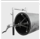
Для надежного снятия оксидного слоя на трубах большого диаметра из ПЭ-НД d 800-d 1200 в диапазоне SDR 11 - SDR 33. Модульная конструкция для простого обращения и быстрого монтажа. Быстрый подбор соответствующего диаметра. Находящийся по центру привод управляется приводной рукояткой. Автоматическая компенсация овальности трубы и допусков посредством подпружиненного резца и автоматической подачи. Поворотный резец имеет две режущие поверхности (двойной срок службы).
