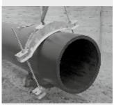
Используется для придания круглой формы овальным трубам из ПЭ-НД диаметром d 800 - 1200 мм.
