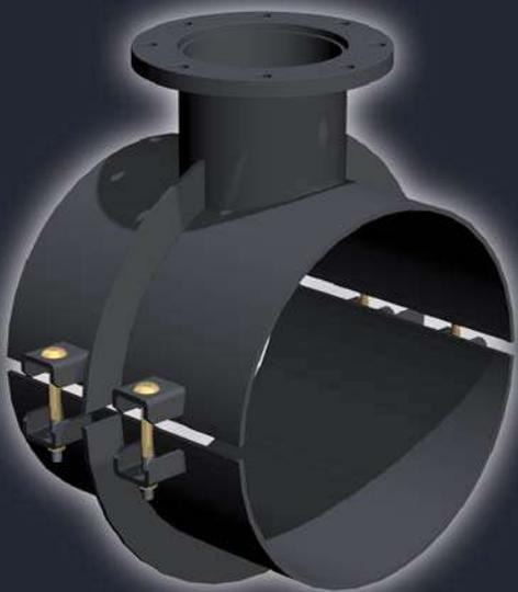
**ФЛАНЦЕВЫЕ ХОМУТЫ НА 45°:** - это хомутовый отвод, выполненный из двух частей с выходом под фланец для монтажа на трубопроводах под давлением из любого материала (PE, ПВХ, Чугун, Сталь, Стеклопластик, Асбоцемент); возможность изготовления ответвления с фланцем любого типа.
