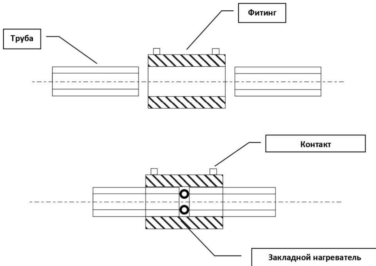
Электромуфтовую сварку необходимо выполнять в соответствии с рекомендациями производителя используемого фитинга, а также со следующими общими принципами:
