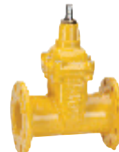
Серия 02/70 Задвижка клиновья фланцевая с увеличенной строительной по DIN F5 DN40-500 PN10/16 Высокопрочный чугун
