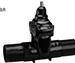
Серия 46/70 Задвижка клиновья с длинными патрубками DN50-600 PN16 GP240GH Наружное покрытие PUR
