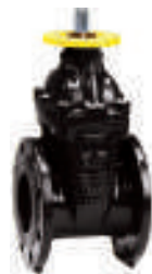
Серия 15/78 Задвижка клиновья фланцевая с верхним ISO фланцем DN50-400 PN10/16 Высокопрочный чугун Наружное покрытие PUR
