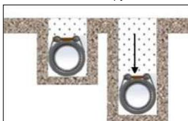
2 Для тройников (например, бетонный блок)
