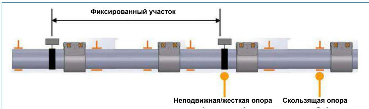
Между двумя неподвижными точками продольная деформация не должна превышать допустимые значения для места соединения.
