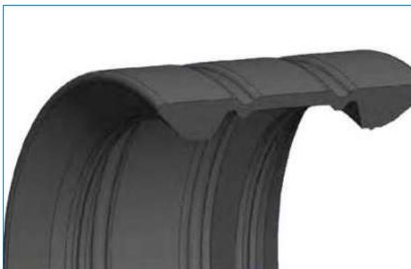
действия. Благодаря сферической форме анкерного кольца зубья обладают высокой жесткостью на верхушке и обеспечивают надежное сцепление даже в случае жестких материалов труб. Это особенно важно в случае тонкостенных труб из высококачественной стали и чугуновых труб. Заточка зубьев (5°) обеспечивает очень хорошее сцепление и в случае металлических труб с покрытием, поскольку зубья проникают через покрытие, и анкерное крепление действует непосредственно на основу трубы.
