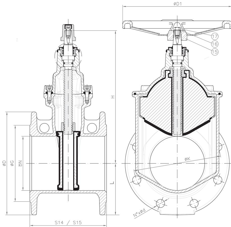
Рис. 1: Чертеж задвижки от DN40 до 300
