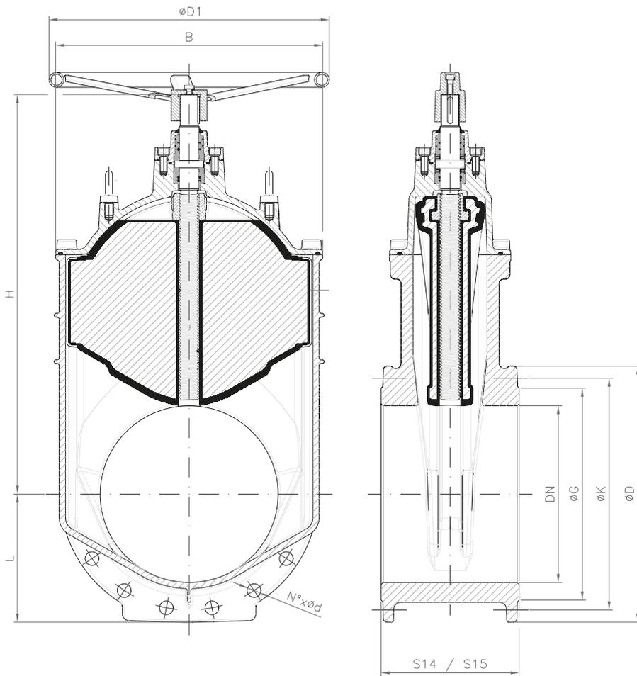
Рис. 2: Чертеж задвижки от DN350 до 600
