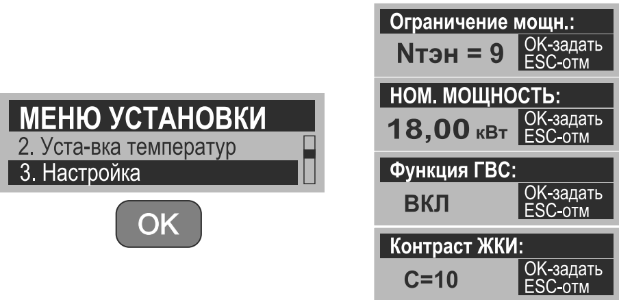
Рис. 9. Меню функции ГВС и ограничения мощности котла
