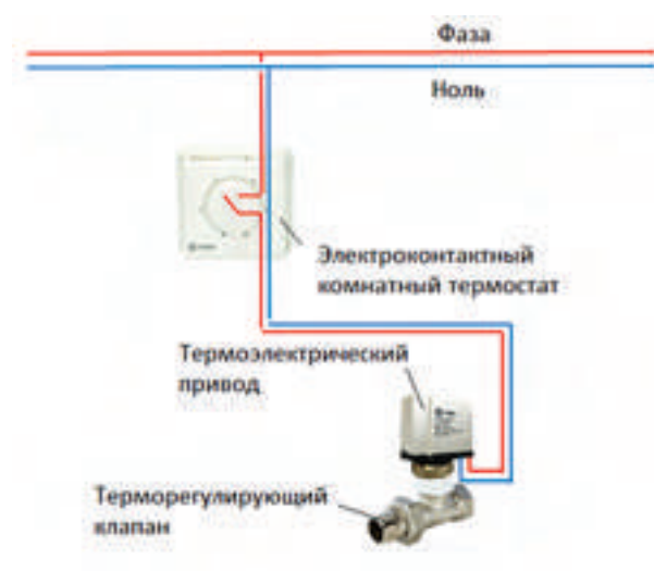
Рис. 3. Схема электрических соединений сети управления
