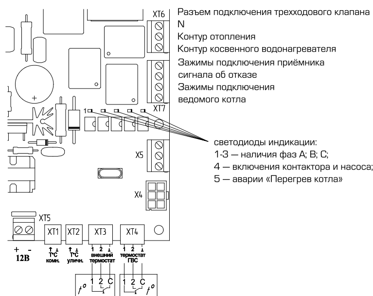
Рис. 5. Расположение разъемов на плате контроллера
