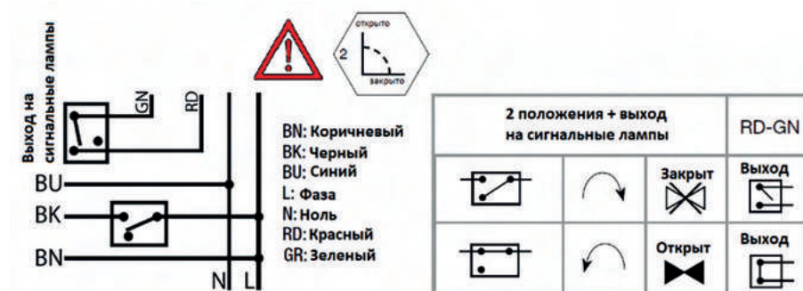
Рис. 22. Схемы электрических соединений привода для зонального клапана с шаровым затвором
