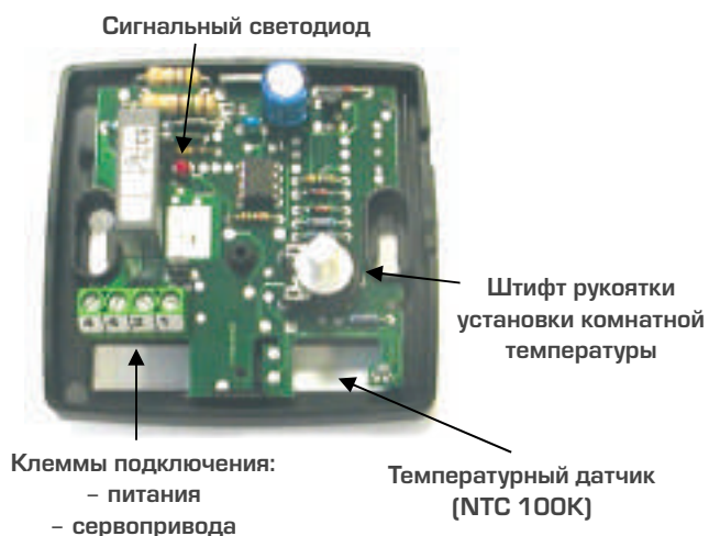
Рис. 12. Устройство электронного термостата для напольного отопления
