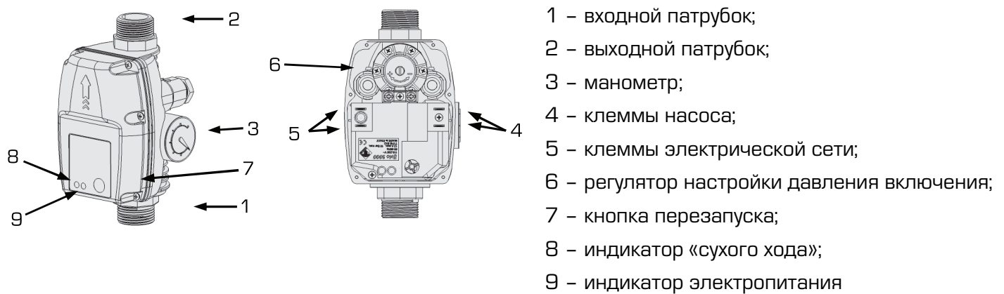
Рис. 38. Элементы устройства управления насосом
