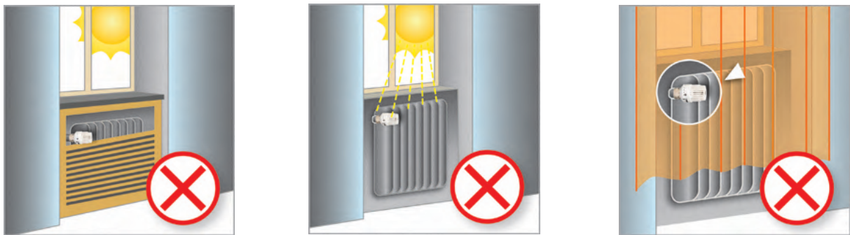
Рис. 8. Требования по размещению автоматического терморегулятора
