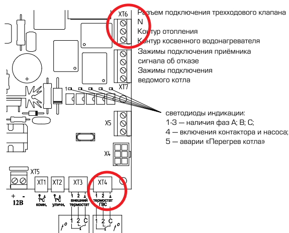
Рис. 13. Схема подключения датчика температуры бойлера
