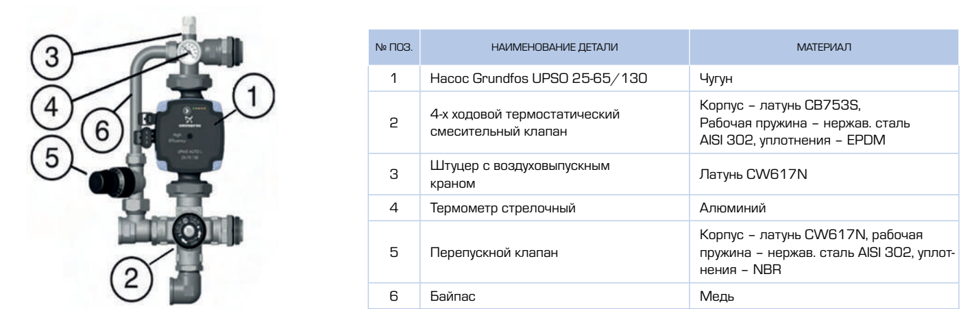
Рис. 3. Устройство смесительного насосного узла для «теплого пола»
