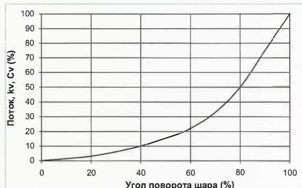
Потоковые характеристики шарового крана ELGEF Plus
