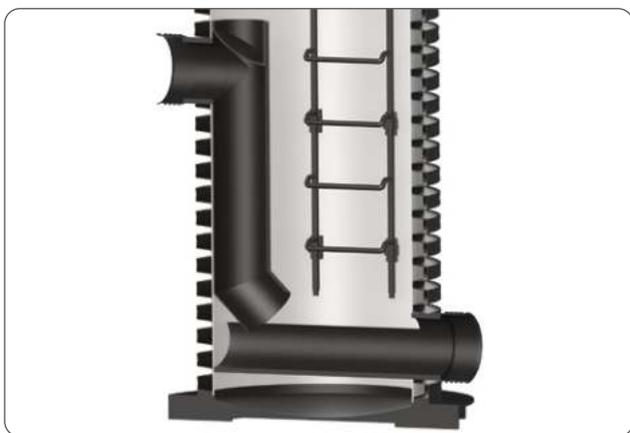
Вход/выход, DN/OD: 160, 200, 250, 315, 400 мм
