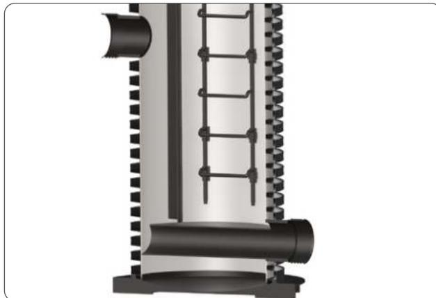
Вход/выход, DN/OD: 160, 200, 250, 315, 400, 500, 630 мм
