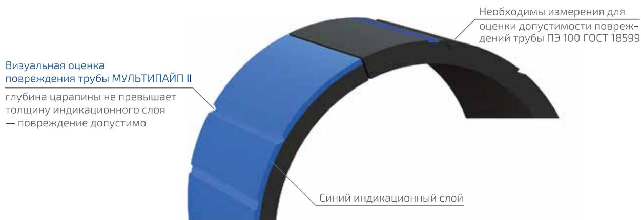
**Конструкция и материалы:** многослойные трубы со слоями из стойкого к растрескиванию полиэтилена ПЭ 100-RC.
