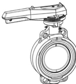
8. Завершите сборку рукоятки, закрепляя её с помощью шайб и гаек.
