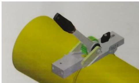
**5. При помощи рукоятки (принцип трещотки) происходит движение устройства по трубе и снятие внешнего грата.**
