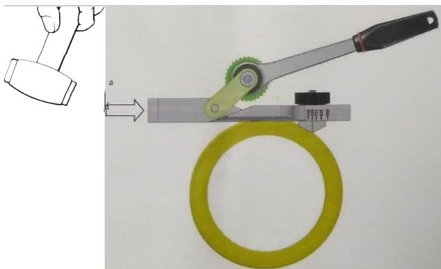
**3,4. При помощи рукоятки зафиксируйте прижимное колесо на внешнем грате и зафиксируйте устройство в зависимости от диаметра трубы при помощи нижней планки**
