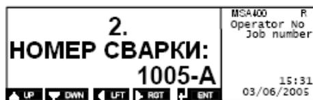
Если функция Z46 активна, то второй номер сварки изменяется в 0000-\_. Цифры автоматически изменяются на 1 при каждой следующей сваркой и отображаются на экране с возможностью изменения. Буквенный символ автоматически переключается в «пробел».
