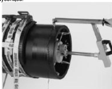
5. Удалить оксидный слой полиэтилена при помощи подходящего зачистного инструмента (с учетом требований к минимально допустимой толщине стенки трубы). Трубы после скругления подвергают непрерывной зачистке до тех пор, пока муфта не наденется на трубу без затруднений. Нарушение требований по наименьшему допустимому диаметру зачистки не допускается (см. п. 3)! Многократная зачистка с целью охвата всей поверхности схлопнутого края трубы не обязательна!
