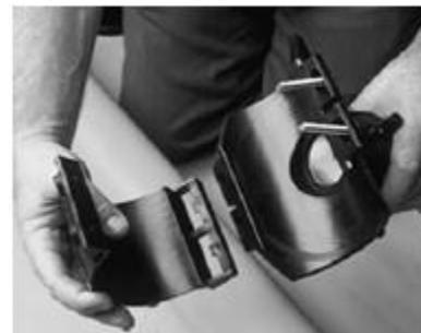
3. Не прикасаясь к свариваемым поверхностям, извлечь седелку из упаковки. Собрать шарнирное соединение, убедиться в том, что выступы нижней части правильно входят в проушины верхней части. Чтобы облегчить процесс установки винтов и упростить процесс монтажа, рекомендуется вернуть стяжные винты до установки седелки на трубу.
