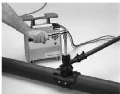
11. Снять винтовой или сварной колпачок.
