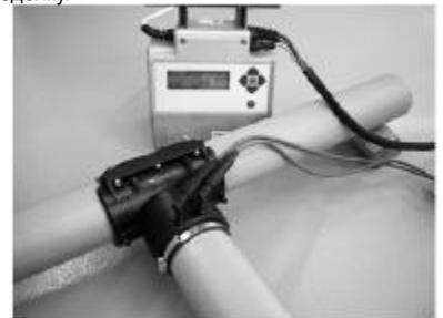
6. Произвести сварку согласно прилагаемой к сварочному аппарату инструкции. Следить за тем, чтобы отводная труба при этом оставалась на заданной глубине вставки.
