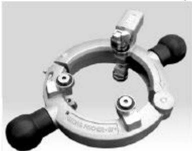
1. Протереть отводную трубу в месте сварки. При помощи поворотного зачистного инструмента равномерно снять оксидный слой полиэтилена, соблюдая требования к минимально допустимой толщине стенки трубы. Длина зачищенного участка должна быть не меньше глубины вставки отвода в седелку.
