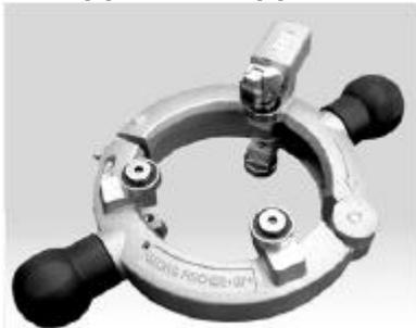
1. Протереть трубу в месте сварки. При помощи поворотного зачистного инструмента равномерно снять оксидный слой полиэтилена, соблюдая требования к минимально допустимой толщине стенки трубы. Длина зачищенного участка должна немного превышать ширину седелки.
