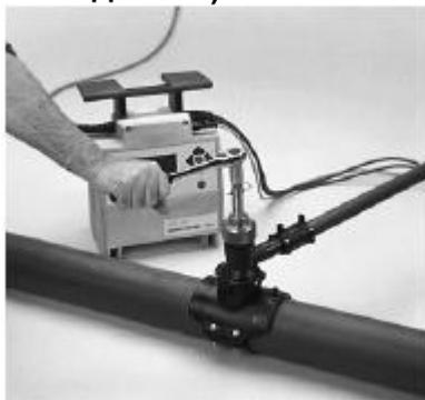
С помощью крестовой отвертки, слегка надавить на штуцер и повернуть его таким образом, чтобы он вошел во фрезу. После этого повернуть отвертку на четверть оборота по часовой стрелке. Шпилька штуцера войдет в зацепление с выемкой фрезы.
