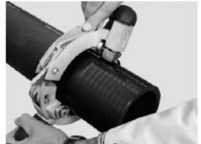
3. Протереть отводную трубу в месте сварки. При помощи поворотного зачистного инструмента равномерно снять оксидный слой полиэтилена, соблюдая требования к минимально допустимой толщине стенки трубы. Длина зачищенного участка должна быть не меньше глубины вставки отвода в седелку.
