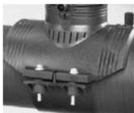
1. Крепеж седелок диаметром 63-160 мм осуществляется при помощи двух винтов. Чтобы зафиксировать седелку относительно трубы, необходимо попеременно затянуть эти винты до упора.
