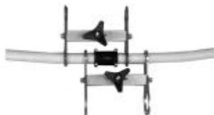
Пара наложенных со смещением относительно соединения трубных зажимов образует четверенный зажим, позволяющий свести механическое напряжение на стыке практически к нулю.
