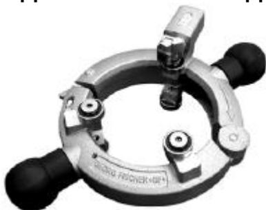
1. Протереть трубу в месте сварки. При помощи поворотного зачистного инструмента снять оксидный слой полиэтилена, соблюдая требования к минимально допустимой толщине стенки трубы.
