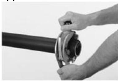
2. При помощи поворотного зачистного инструмента равномерно снять оксидный слой, соблюдая требования к минимально допустимой толщине стенки трубы.
