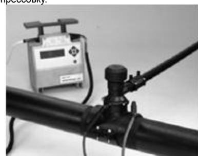
14. Произвести сварку согласно прилагаемой к сварочному аппарату инструкции.
