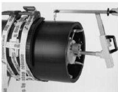
4. Установить зачистной инструмент (например, RTC 710) и отрегулировать его ход на требуемую длину зачистки. Однократно провернув инструмент по всей окружности (без резца), проверить цилиндричность трубы. При необходимости, восстановить цилиндричность в соответствии с "Руководством по установке муфт большого диаметра с помощью обжимного комплекта" (поставляется вместе с прижимным комплектом).
