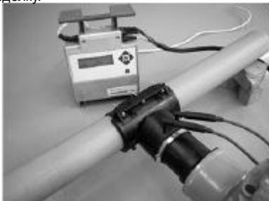
4. Произвести сварку согласно прилагаемой к сварочному аппарату инструкции. Следить за тем, чтобы отводная труба при этом оставалась на заданной глубине вставки.
