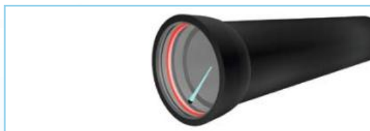
6. Смазка внутренней поверхности уплотнительного кольца
