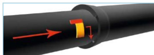
5. Стыковка труб и установка правого стопора
