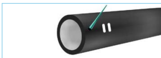
3. Смазка наружной поверхности гладкого конца трубы
