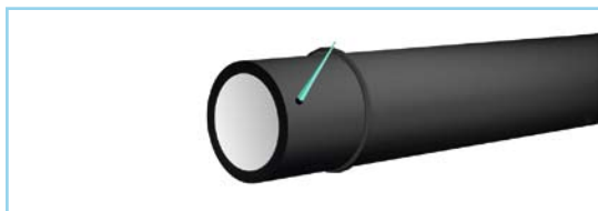
2. Смазка наружной поверхности гладкого конца трубы
