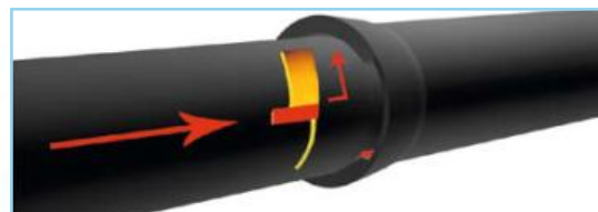
6. Установка левого стопора. Фиксация стопорной проволокой
