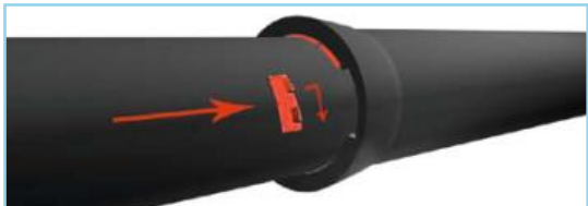
6. Стыковка труб и установка стопоров
