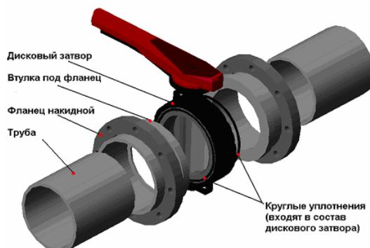
При соединении участков пластикового трубопровода можно использовать две втулки под фланец с рифленой контактной поверхностью и плоским или профильным уплотнением, либо одну втулку с рифленой поверхностью и одну втулку с пазом под уплотнение, в котором устанавливается круглое уплотнение.
