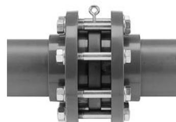
Важное требование при сборке фланцевых соединений заключается в правильном ориентировании накладных фланцев: болты в нижней части фланца должны располагаться по сторонам относительно вертикальной оси в сечении фланца. Тем самым при появлении утечек во фланцевом соединении в самой нижней точке (в месте отрыва капель) будет свободное пространство и риск ржавления и повреждения болтов будет минимальным.
