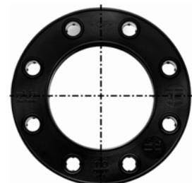
Вторым требованием является соблюдение момента затяжки болтов. Чрезмерное закручивание болтов может привести к повреждению уплотнения
