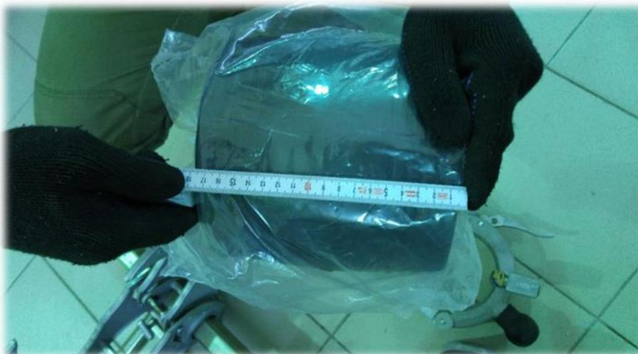
Рисунок 21 — Измерение соединительной муфты
