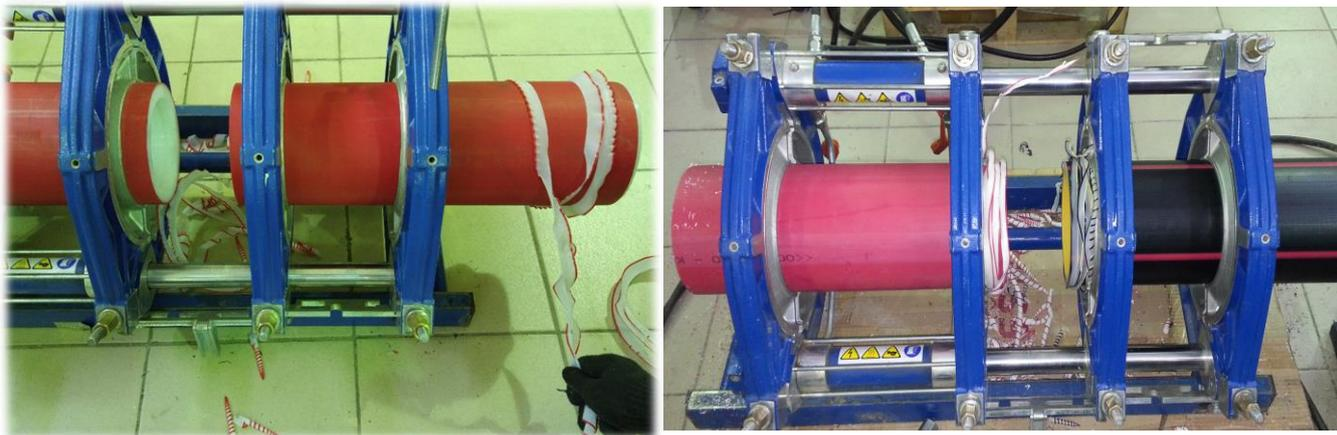
Рисунок 10 — Контроль снятой стружки
