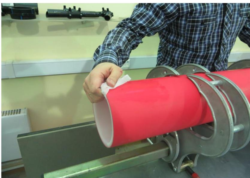
Рисунок 24 — Очистка поверхности трубы
