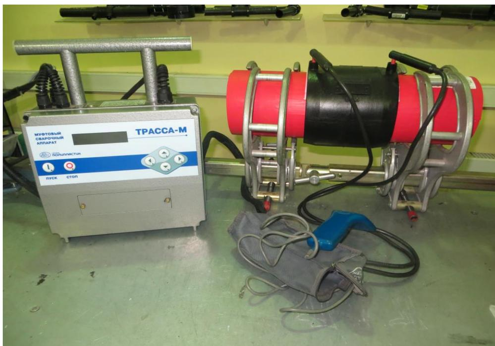
Рисунок 27 — Подключение сварочного аппарата
