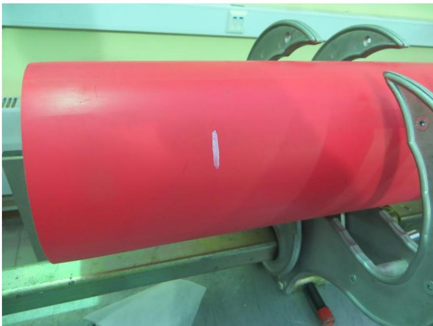
Рисунок 26 — Отметка глубины посадки муфты на трубе
