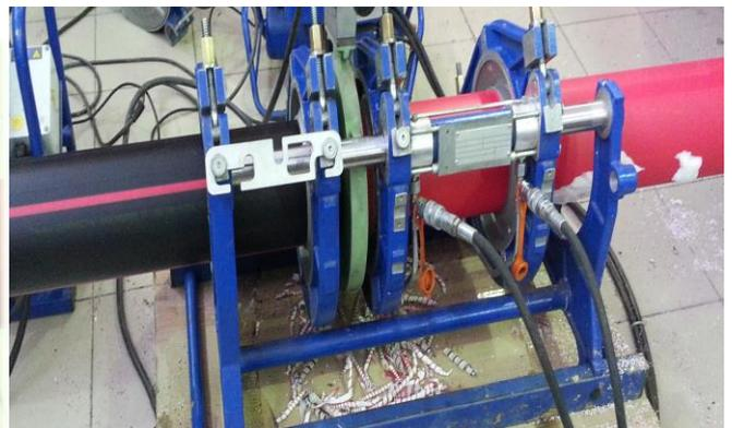
Рисунок 13 — Установка нагретого инструмента
