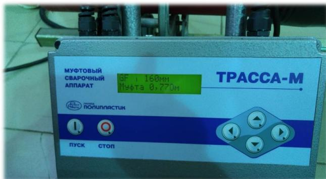
Рисунок 28 — Считывание штрих-кода с муфты.
