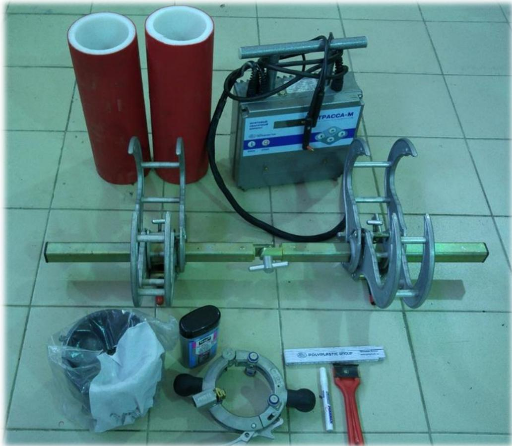
Рисунок 20 — Общий вид инструментов, необходимых для проведения сварки при помощи муфт с закладными нагревателями
