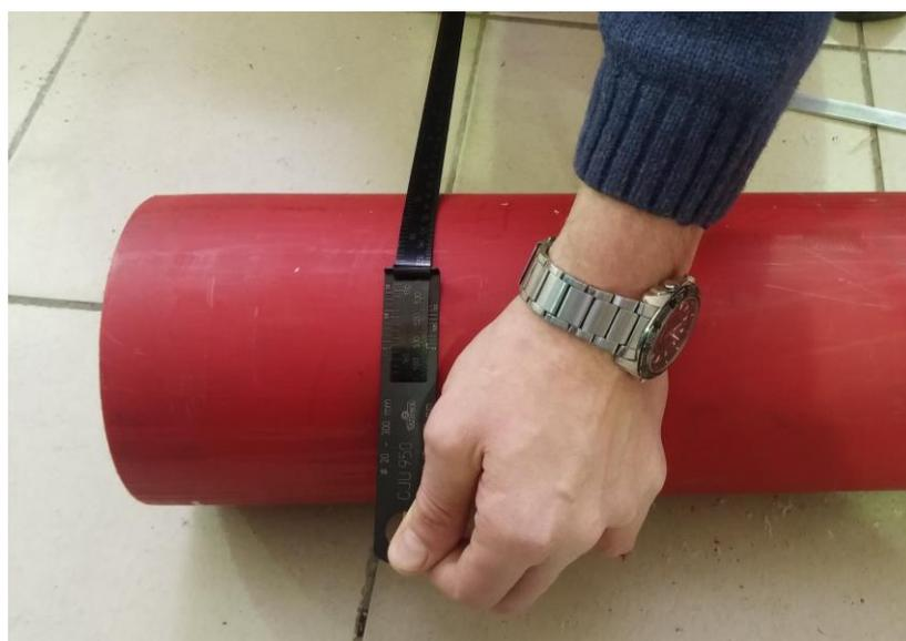
Рисунок 4 — Измерение наружного диаметра при помощи циркулем
