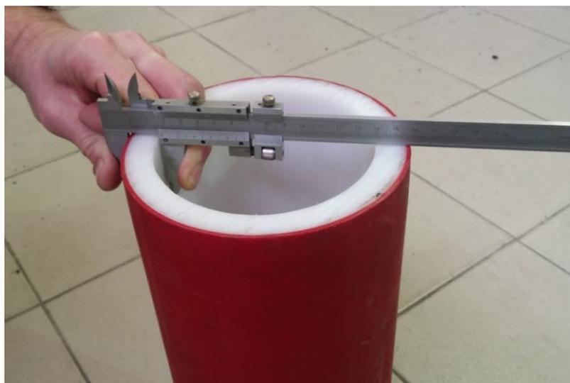
Рисунок 3 — Измерение толщины стенки
